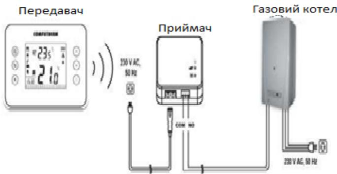
Радіус дії передавача сигналу у відкритій місцевості складає приблизно 100 м. Ця відстань значно скорочується всередині будівлі при наявності металевих або залізобетонних конструкцій, а також при глиняних стінах, які заважають проходженню радіохвиль.
