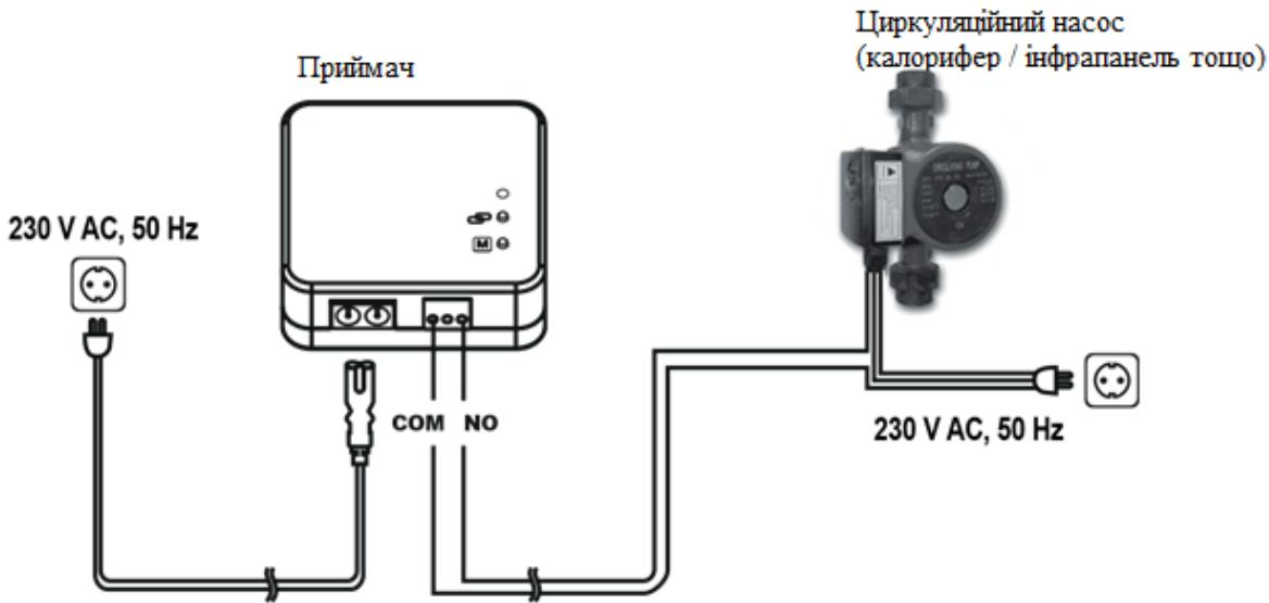
**УВАГА!** При приєднанні завжди враховуйте навантажувальну здатність реле термостата і дотримуйтесь інструкцій виробника нагрівача або кондиціонера. Приєднання повинен виконувати фахівець!
