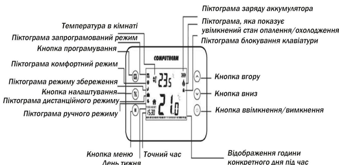
Пристрій складається з двох блоків. Перший - переносний блок управління (термостат), другий - блок приймача, що управляє котлом. Між двома блоками існує бездротовий (радіочастотний) зв'язок, тому немає необхідності прокладати провід між термостатом і котлом.
