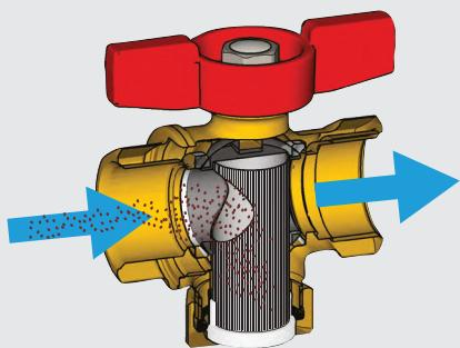
Когда кран открыт, теплоноситель проходит через фильтр, затем он замедляется, чтобы обеспечить отделение твердых частиц. Примеси фильтруются при прохождении через металлическую сетку и попадают на дно колпачка. Специальная структура корпуса крана позволяет эксплуатировать всю поверхность фильтра, увеличивая время работы краны без очистки фильтра.
