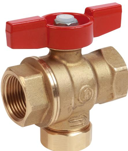
Шаровой кран полнопроходной со встроенным фильтром для контроля и обслуживания в системах отопления, вентиляции и кондиционирования. Шаровый кран R701F является идеальным решением для гидравлических систем, требующих установки фильтра и запорных клапанов в ограниченном пространстве (например, для подключения теплосчётчиков, циркуляционных насосов, для обвязки котлов или на входах теплового насоса.)
