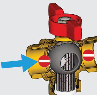
Когда клапан закрыт, теплоноситель не может проходить через фильтр, так как он изолирован от остальной части гидравлического контура. В этом положении можно ослабить нижний колпачок и вытащить фильтр, чтобы промыть его чистой водой и восстановить поверхность фильтрации.
