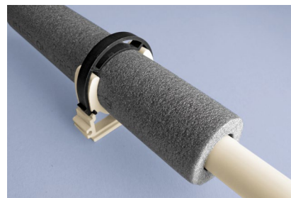
Для гарячої води хомут більшого розміру встановлюється поверх ізоляції
